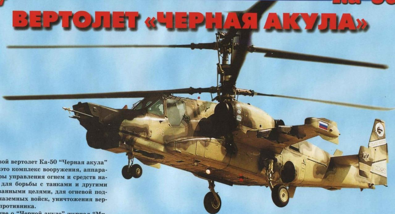
**Б**оевой вертолет Ка-50 «Черная акула» — это комплекс вооружения, аппаратуры управления огнем и средств навигации для борьбы с танками и другими бронированными целями, для огневой поддержки наземных войск, уничтожения вертолетов противника.
