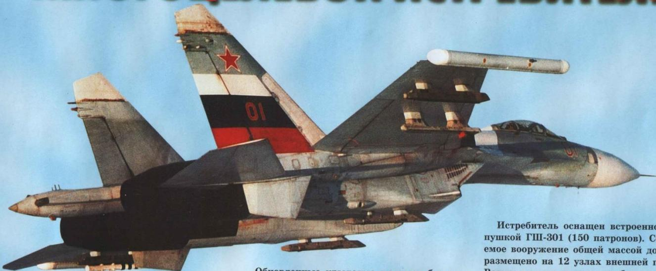
Знаменитый Су-30 является модернизированным вариантом хорошо известного истребителя Су-27. Он предназначен для борьбы с воздушными целями, а также для действий по наземным (морским) целям с использованием широкого спектра управляемого и управляемого, в том числе высокоточного, оружия днем и ночью, в простых и сложных метеоусловиях.
