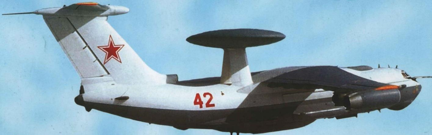
**К**омплекс А-50 предназначен для обнаружения и опознавания воздушных объектов (в том числе и малоразмерных крылатых ракет типа ALCM и "Томагавк"), определения их координат и параметров движения, выдачи информации на командные пункты, наведения истребителей, а также вывода самолетов фронтовой авиации в район наземных целей. Возможно использование А-50 и для обнаружения морских целей.
