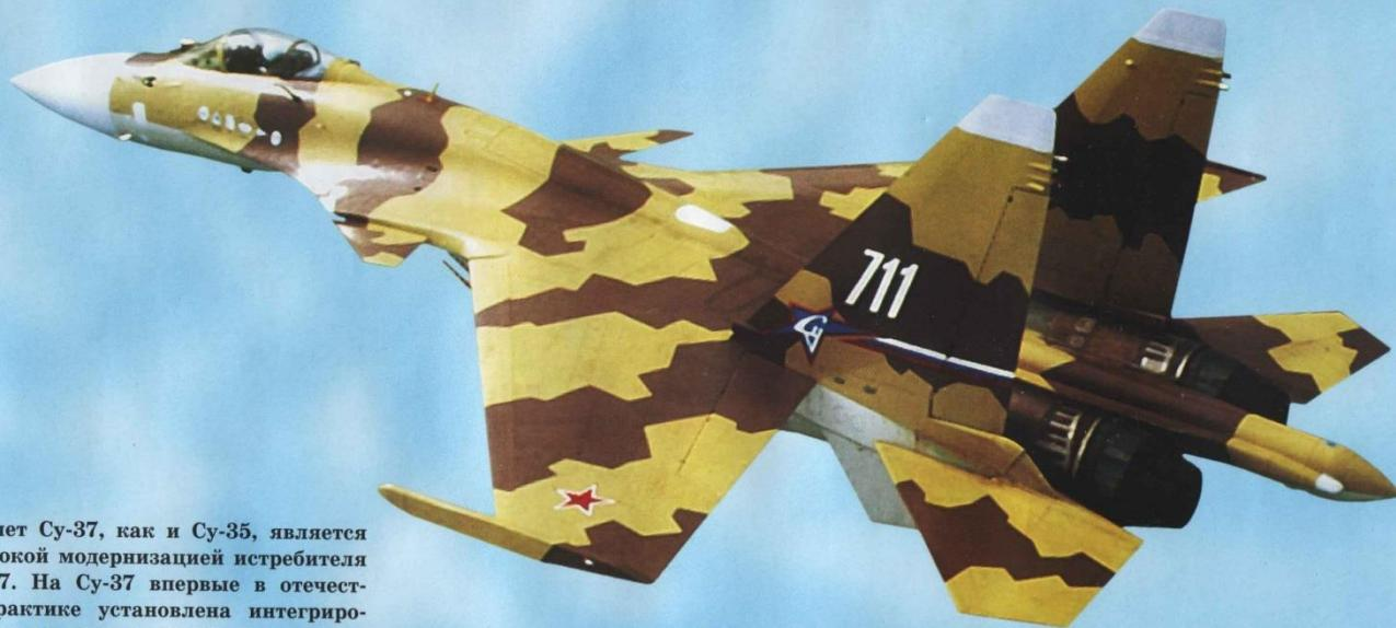
Самолет Су-37, как и Су-35, является глубокой модернизацией истребителя Су-27. На Су-37 впервые в отечественной практике установлена интегрированная система дистанционного управления полетом, которая решает также задачи управления тягой двигателей и автоматического вывода самолета из штопора.
